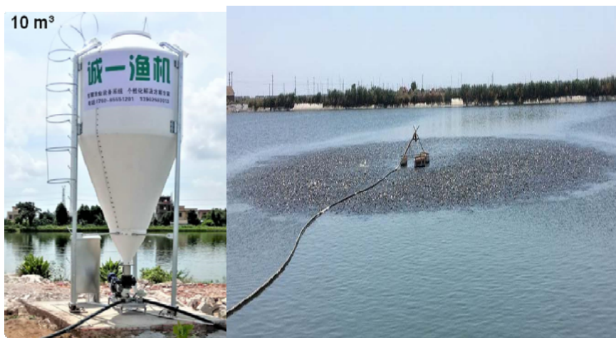
图 3 密封饲料仓和 360° 自动投料机实例
